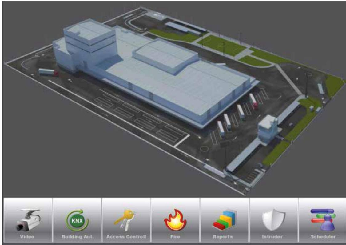
PRO-FIT è una piattaforma Hardware e Software dedicata alla supervisione e gestione coordinata di un insieme di processi logistici e di Building Automation. Tutti i sottosistemi sono integrati nella piattaforma PRO-FIT, che si occupa di realizzare e coordinare le interconnessioni necessarie.
